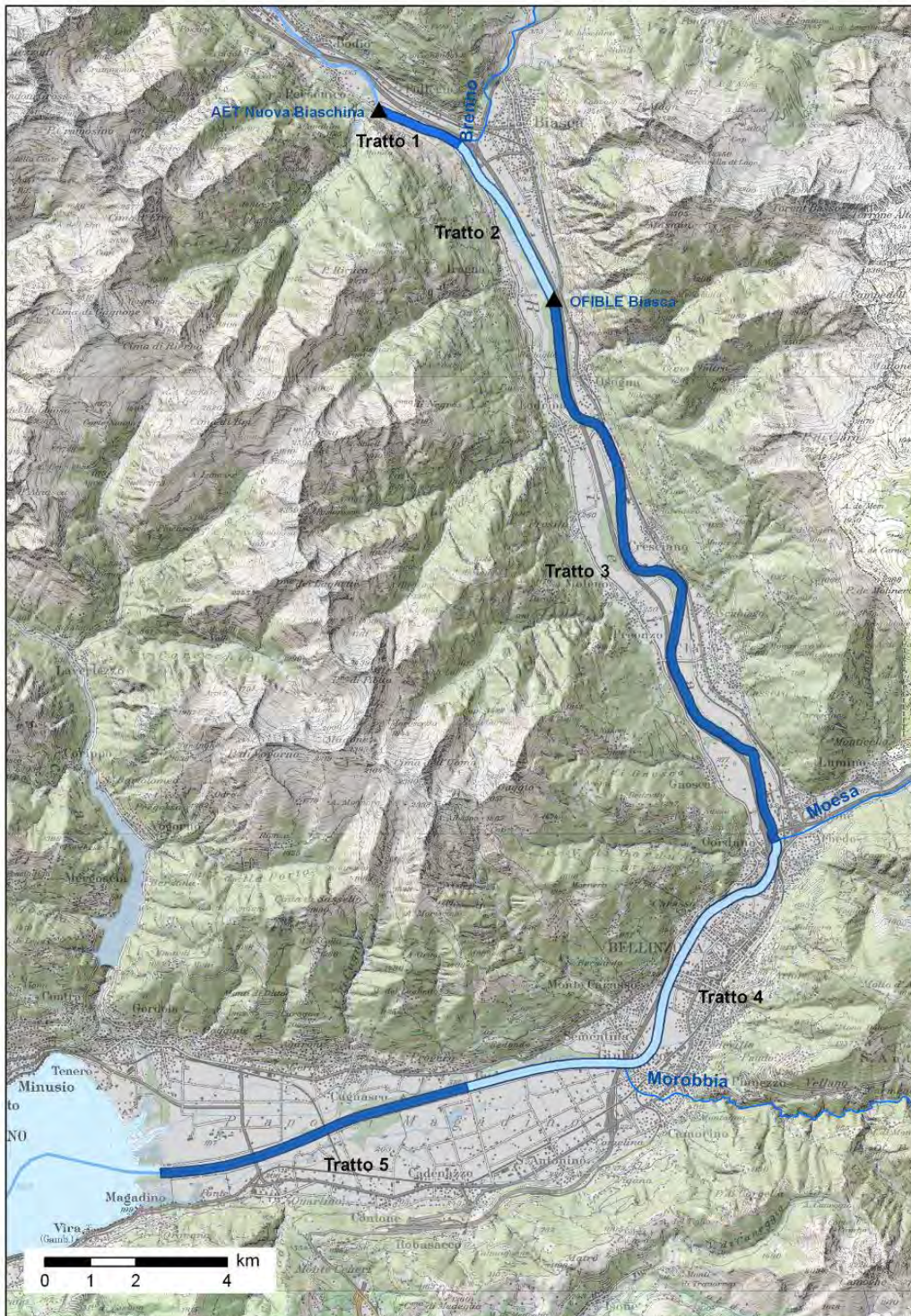
Abbildung 9.5: Schwallstrecke Ticino (aus DRIFT 2011). Tratto = Abschnitt.
