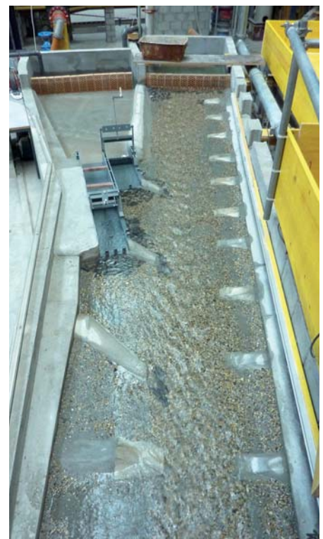
Bild 1. Physikalisches Modell der Einleitung des geplanten Beruhigungsbeckens der Kraftwerke Oberhasli AG in die Hasliaare. Oben links ist ein Teil des Beruhigungsbeckens und oben rechts das Ende der Restwasserstrecke zu sehen. Die Fliessrichtung ist auf diesem Bild von oben nach unten.
