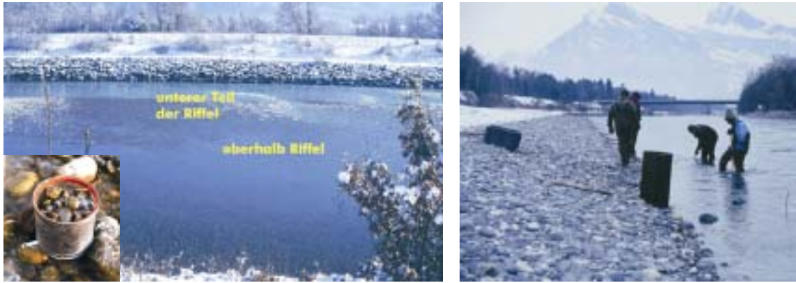
Abb. 9: In situ Untersuchungen zur Entwicklung von Forelleneiern im Alpenrhein. Die modifizierten Vibert-Kästen (kleines Bild) werden an jeder Beprobungsstelle in die drei charakteristischen Flussbettbereiche "oberhalb Riffel" und "unterer Teil Riffel" (linkes Bild) sowie "entlang Kiesbank" (rechtes Bild) eingebracht. Auf dem rechten, bei Sunk aufgenommenen Bild ist anhand der Schneegrenze auch die Lage der Uferlinie bei maximalem Schwall zu erkennen. Aus ARGE TRÜBUNG ALPENRHEIN (2001).
