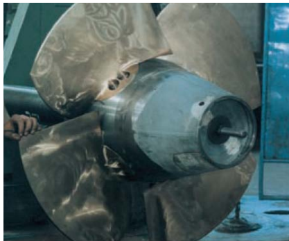
Roue Kaplan avec pales réglables
