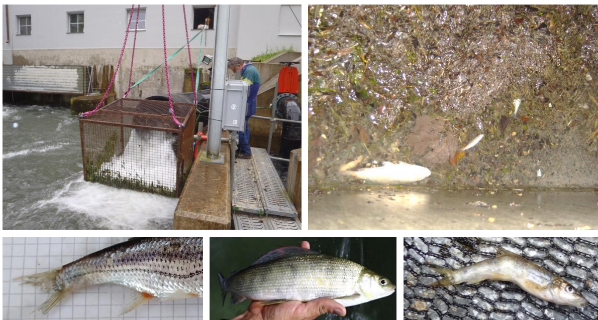
Oben: Auffangen des Geschwemmsels unterhalb eines Bypasses mit speziellem Fangkorb; Mulde mit Rechengut und toten Fischen. Unten: Schneider mit Schädigung Schwanzflosse, Äsche mit Rechenabdruck, Barbe mit Bruch Rückgrat (Aquarius)
