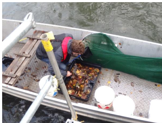
Fangvorrichtung Fangkorb, anschliessender Hamen sowie Kran, Plattform und Boot zum Heben, Leeren und Reinigen der Gerätschaft (Aquarius)
