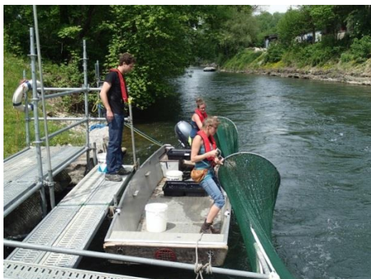
Fangvorrichtung Fangkorb, anschliessender Hamen sowie Kran, Plattform und Boot zum Heben, Leeren und Reinigen der Gerätschaft (Aquarius)
