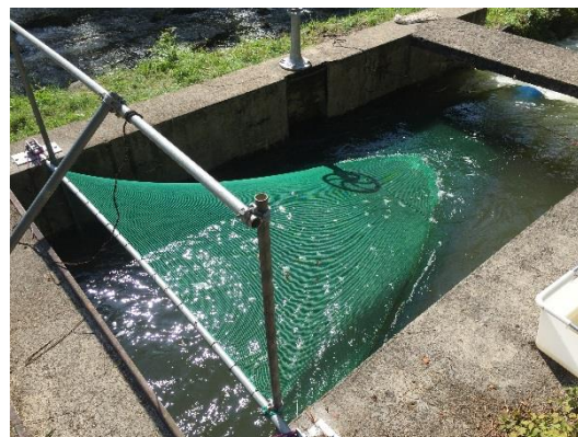
Netzreuse für Bypasskontrollen sowie Hamen in einem Unterwasserkanal der Sihl (AquaPlus)
