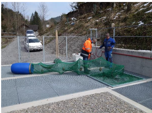
Netzreuse für Bypasskontrollen sowie Hamen in einem Unterwasserkanal der Sihl (AquaPlus)
