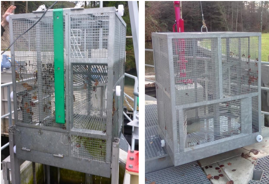
Abb. 1 Einstieg in die Reuse für aufsteigende Fische (linkes Foto) und für absteigende Fische (rechtes Foto). Fotos: J. Guthruf.
