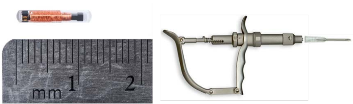
Abbildung 16: links: Passive-Integrated-Transponder (PIT) Tag mit 12 mm Länge. Die Kupferspule dient der Ladung des Chips und Übertragung des individuellen Codes. Rechts: handelsüblicher Injektor für PIT-Tags mit wechselbarer Kanüle.
