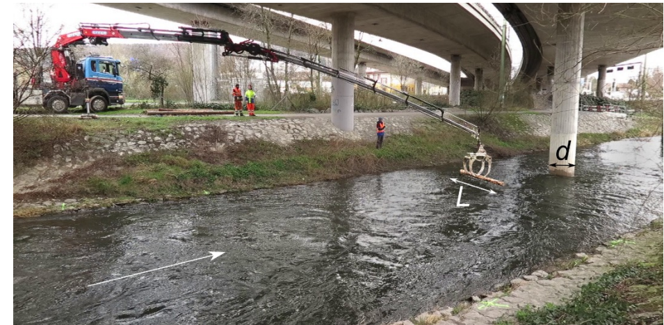
Schwemmholzzugabe mit Holzlänge L oberstrom des Brückenpfeilers mit Durchmesser d an der Glatt (Zürich), VAW ETH Zürich (Wyss et al., 2022)
