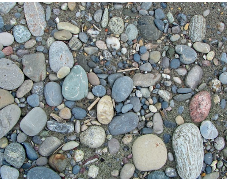
Abb. 16: Sauberes Schüttmaterial. An der Oberfläche überwiegen die groben Komponenten und schützen das unterliegende Feinmaterial vor der Erosion | Fig. 16: Matériau en vrac propre. En surface, les composants grossiers prédominent et protègent les matériaux fins en-dessous contre l'érosion
