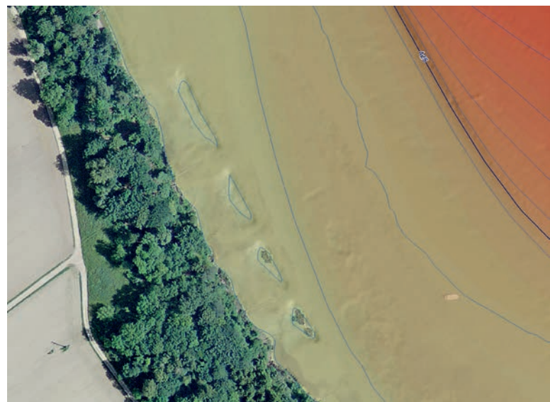
Abb. 9: Dieselben Wellenbrecher in der bathymetrischen Aufnahme von 2016. Die durch die Wellenbrecher verursachten Auflandungen sind messbar [Geoportal des Kantons Bern] | Fig. 9: Les mêmes brise-lames dans le relevé bathymétrique de 2016. Les atterrissements causés par les brise-lames sont mesurables [Géoportail du canton de Berne]
