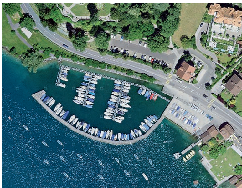
Abb. 15: Gekrümmte Schwimmole bei Hilterfingen am Thunersee [map.geo.admin.ch] | Fig. 15: Jetée flottante courbée près de Hilterfingen sur le lac de Thoune [map.geo.admin.ch]
