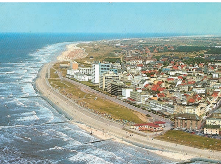
Abb. 10: Molen an der Küste der Insel Nordeney, Nordsee. Die uferparallelen Brandungsströmungen, welche den Sedimenttransport und den Uferrückgang bewirken, werden verhindert | Fig. 10: Jetées sur la côte de l'île Nordeney, en mer du Nord. Les courants de vagues parallèles au rivage, qui provoquent le transport de sédiments et le recul du rivage, sont empêchés
