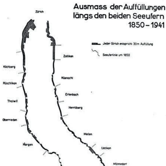
Abb. 3: Auffüllungen entlang dem Zürichsee [Bänziger 2006] | Fig. 3: Remplissages le long du lac de Zurich [Bänziger, 2006]
