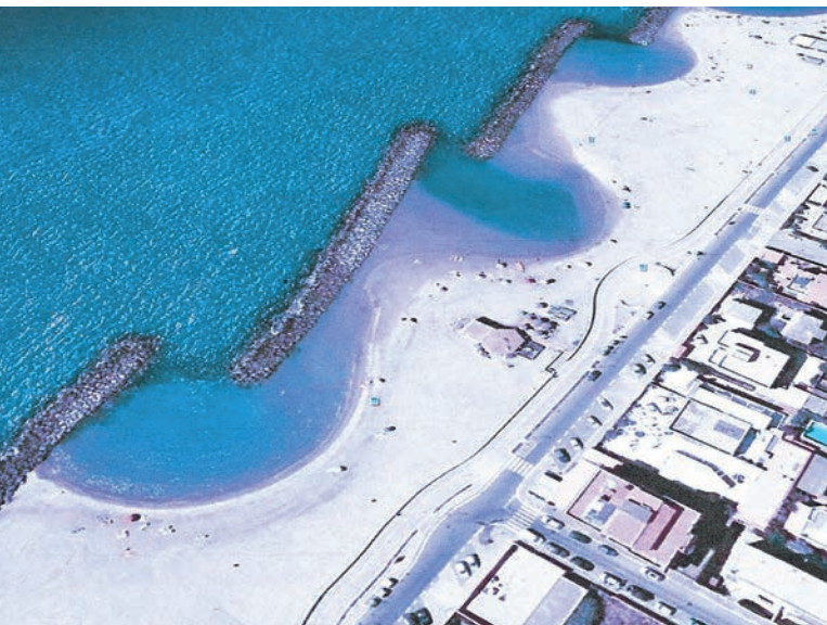
Abb. 7: Wellenbrecher mit Tombolos an der Mittelmeerküste in Italien. Mit diesen baulichen Massnahmen kann der Badestrand vor der Erosion geschützt werden | Fig. 7: Brise-lames isolés avec tombolos sur la côte méditerranéenne en Italie. Grâce à ces mesures de construction, la plage peut être protégée contre l'érosion
