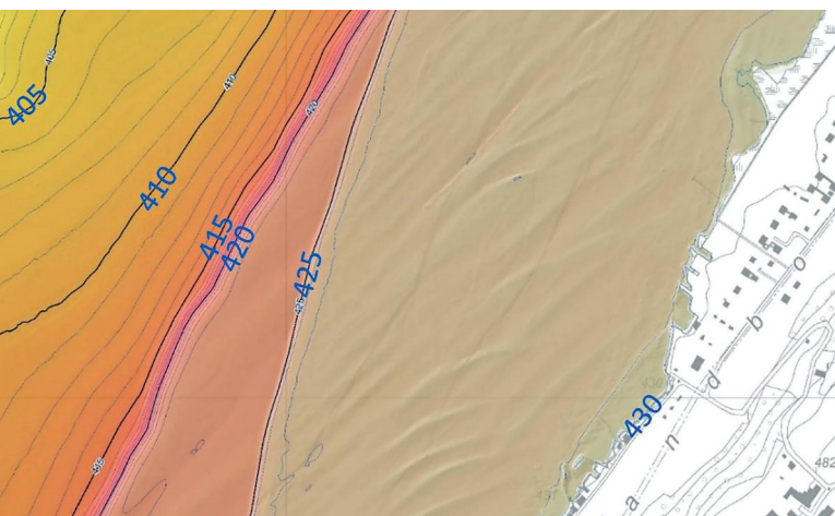
Abb. 3: In der Flachwasserzone bei Gerolfingen ist die Haldenkante auf der Höhe von ca. 424 m ü.M. gut sichtbar. Sie liegt somit rund 5,5 m unter dem mittleren Wasserstand, was ungefähr der halben signifikanten Wellenlänge bei einem 2-jährlichen Westwindereignis und damit der natürlichen Tiefenlage der Haldenkante entspricht. Weiter landwärts befindet sich ein Kliff von rund 2 m Höhe. Gut sichtbar sind auch die Dünen, welche auf eine aktive wellen- und strömungsbedingte Sedimentdynamik hinweisen. [Bathymetrie Bielersee © Amt für Wasser und Abfall des Kantons Bern. Quelle: Tiefenkarte Bielersee, Geoportal des Kantons Bern]. | Fig. 3 : Dans la beine lacustre près de Gerolfingen, le mont est clairement visible à une altitude d'environ 424 m.s.m. Il se trouve donc à environ 5,5 m sous le niveau moyen de l'eau, ce qui correspond à la moitié de la longueur d'onde significative d'un épisode de vent d'ouest bisannuel et donc à la profondeur naturelle du mont. Plus loin vers la terre ferme se trouve une falaise d'environ 2 m de hauteur. Les dunes sont également bien visibles, ce qui indique une dynamique sédimentaire active induite par les vagues et les courants. [Bathymétrie du lac de Biene © Office des eaux et des déchets du canton de Berne. Source : carte des profondeurs du lac de Biene, Géoportail du canton de Berne].
