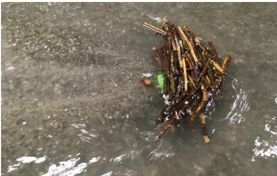
Hochwassersimulation mit Verklaugung
