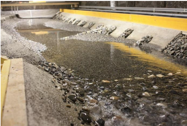
Simulation Niederwasser mit umströmter Lenkbuhne
