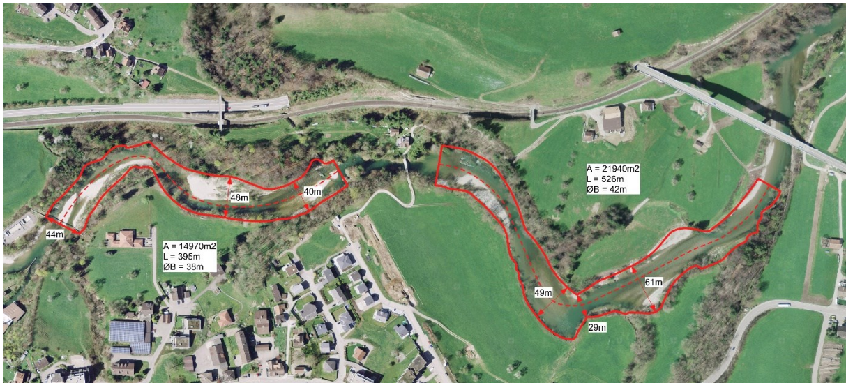
Abb. 38 Thur bei Lichtensteig mit zwei Referenzstrecken. A: Fläche Gewässersohle (dynamischer Bereich); L: Abschnittslänge; ØB: Mittlere Sohlenbreite. Zwischen den zwei Referenzstrecken befindet sich eine natürliche Engstelle (Fels).
