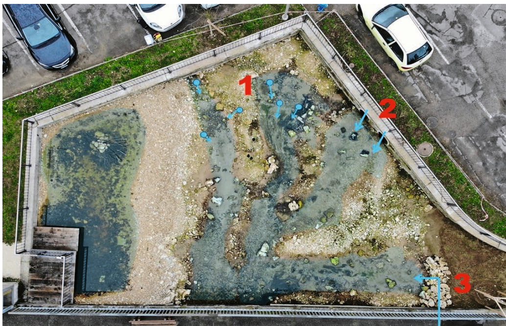
Fig. 3 Après travaux, mars 2024. 1: Par temps sec, toute l'eau arrive depuis les résurgences. 2: Par temps de pluie, la nappe phréatique remonte et l'eau arrive principalement par les tuyaux de trop-plein d'une source voisine. 3: Afin d'avoir plus d'eau fraîche, l'ancien captage du village a été connecté à la zone de source par un tuyau de dérivation.
