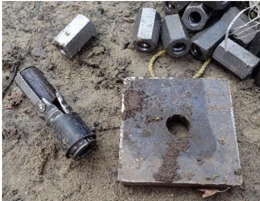
Abbildung 3: Spreizdübel, Unterlagsplatte und Muttern.
